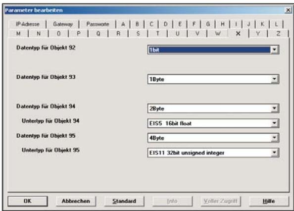
En los parámetros del acoplador de red se establecen los tipos de datos de los 104 objetos de visualización.
